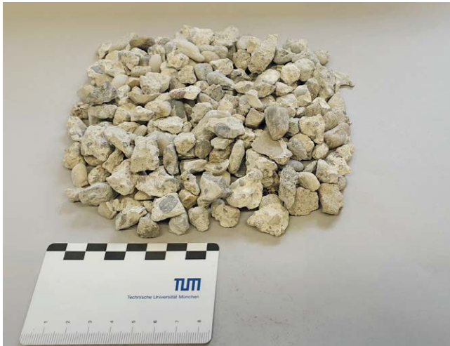
Aufbereitete RC-Beton-Gesteinskörnung 8/16 (Typ 1 nach DIN 4226-101; Mindestanteil der Stoffgruppe „Beton“ beträgt 90 M.-%).
