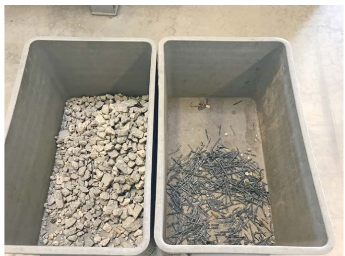
Ergebnis kamerabasierte Sortierung von Carbonbetonabbruchmaterial.
