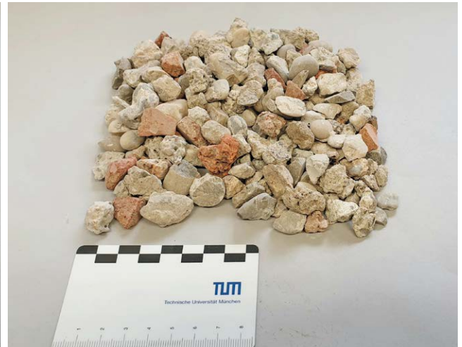
Aufbereitete RC-Beton-Gesteinskörnung 8/16 (Typ 2 nach DIN 4226-101; Mindestanteil der Stoffgruppe „Beton“ beträgt 70 M.-%).
